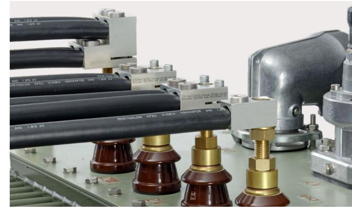
Die 2DIREKT wird direkt am Verteiltransformator angeschlossen und macht Fahnen, Kabelschuhe, Hülsen und Muttern überflüssig.
